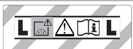
**ATTENZIONE:** Questo apparecchio contiene polveri nocive alla salute. Le operazioni di svuotamento e di manutenzione, inclusa la rimozione del sacchetto della polvere possono essere eseguite solo da personale specializzato indossando un equipaggiamento adatto alla protezione personale. Non attivare prima della completa installazione del sistema di filtraggio.
