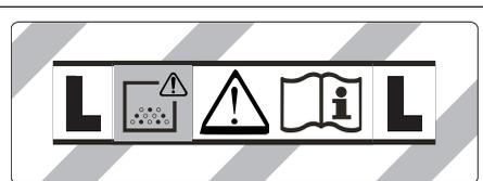
**FIGYELMEZTETÉS:** Ez a készülék egészségre veszélyes port tartalmaz. Kiürítést és karbantartást, beleértve a porzsák eltávolítását is, csak szakképzett személyeknek szabad végezni, akik megfelelő védőfelszerelést viselnek. Ne kapcsolja be, mielőtt a teljes szűrőrendszer nincs felszerelve.
