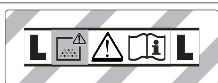
**ПРЕДУПРЕЖДЕНИЕ:** В данном устройстве находится опасная для здоровья пыль. Опорожнение и техническое обслуживание, в том числе, удаление пылесборного мешка, должно проводиться только специалистами, носящими подходящее защитное снаряжение. Не включать до полной установки фильтровальной системы.
