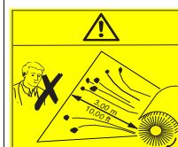
Опасность отбрасывания деталей при работающем подметающем вале. Держаться на безопасном расстоянии (3 м) от передней и боковых частей устройства
