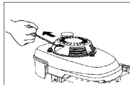
→ Când motorul pornește eliberați cablul de pornire. Pentru începerea lucrului reglați maneta de gaz în poziția „Putere maximă“.
