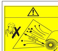
Perigo devido a componentes projectados com rolo varredor em funcionamento. Manter uma distância de segurança de 3 m para a frente e para os lados
