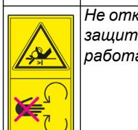
Не открывать и не удалять защитное оборудование при работающем двигателе.
