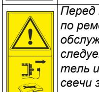
Перед проведением работ по ремонту, техническому обслуживанию и очистке следует остановить двигатель и вынуть наконечник свечи зажигания.
