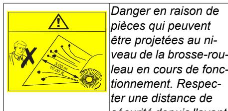
Danger en raison de pièces qui peuvent être projetées au niveau de la brosse-rouleau en cours de fonctionnement. Respecter une distance de sécurité depuis l'avant et sur le côté de 3 m.
