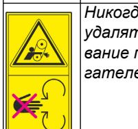
Никогда не открывать и не удалять защитное оборудование при работающем двигателе.
