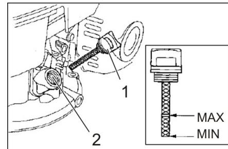
1 Yağ ölçüm çubuğu
