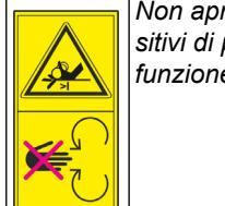
Non aprire o rimuovere i dispositivi di protezione a motore in funzione.
