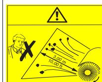
Pericolo da pezzi che schizzano via per il rullospazzola in funzione. Mantenere una distanza di sicurezza in avanti e lateralmente di 3 m
