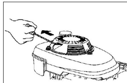
→ Quando il motore gira, rilasciare la fune a strappo dell'avviatore. Per lavorare, mettere la leva dell'acceleratore su posizione „a pieno regime“.
